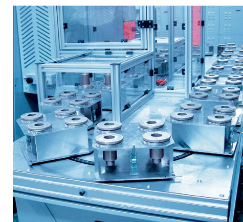
Pallet a 4 posizioni per teste di valvole
