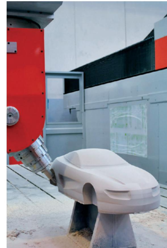
Usinage 5 axes d'un modèle de voiture pour les centres de style
