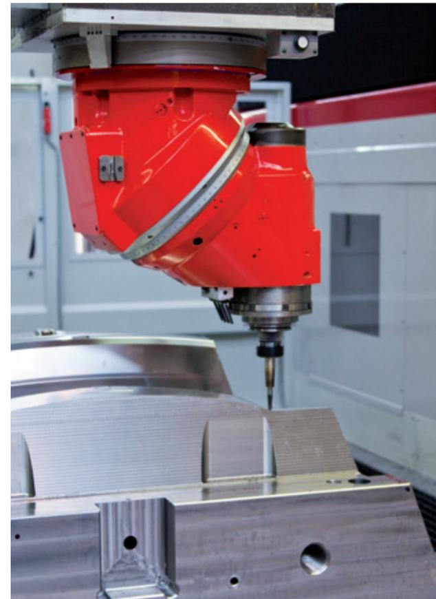
Usinage à grande vitesse de moules d'injection pour pare-chocs dans l'industrie automobile
