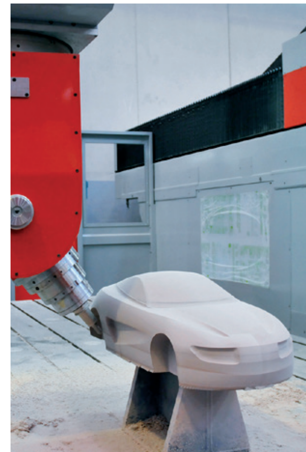
Lavorazione a 5 assi di un modello di automobile per i centri stile
