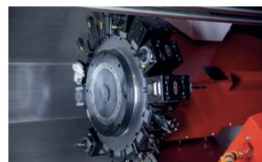
Torretta BMT a 16 posizioni ad azionamento diretto. Vantaggi in termini di precisione del cambio e stabilità dell'interfaccia
