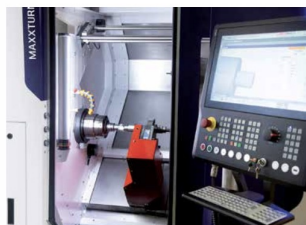
Mandrino principale disponibile in tre dimensioni: standard Ø 65 mm/BigBore Ø 77 mm/SuperBigBore Ø 95 mm
