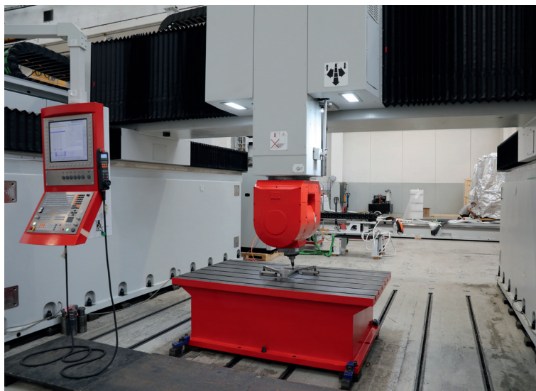
Ein weiteres Highlight bei Emco Mecof ist das Hochgeschwindigkeits-Portalbearbeitungszentrum Dynamill : Die Stärken liegen beispielsweise im Werkzeug-, Modell- und Formenbau – u. a. in der großvolumigen Aluminium-, Stahl- und Ureol-Bearbeitung.
