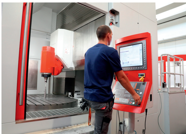
Die UMILL 1500 von Emco Mecof (hier noch vor der finalen Abnahme) bietet Verfahrwege von (X/Y/Z) 1.500 x 1.500 x 1.100 mm: Der Fräskopf ermöglicht mit 15°-Unterschnitt einen Mehrwert bei der Komplettbearbeitung in einer Aufspannung.
